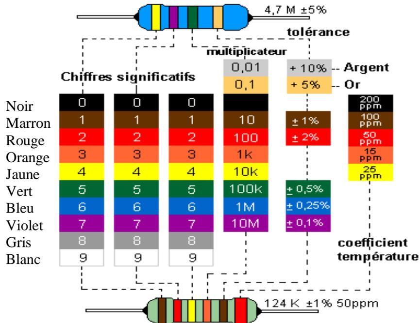
**Q22 :** Mesurer à l'aide du multimètre la valeur de la résistance à disposition
