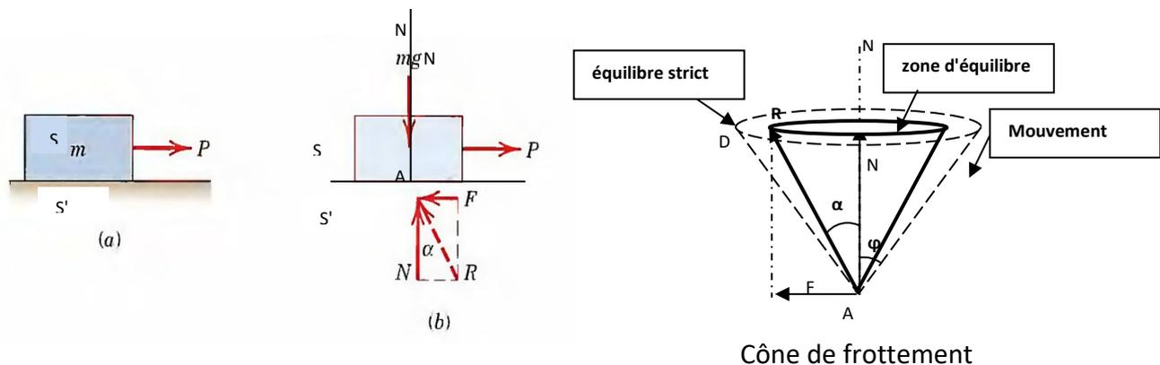
Figure III. 17: Le cône de frottement et condition d'équilibre.
