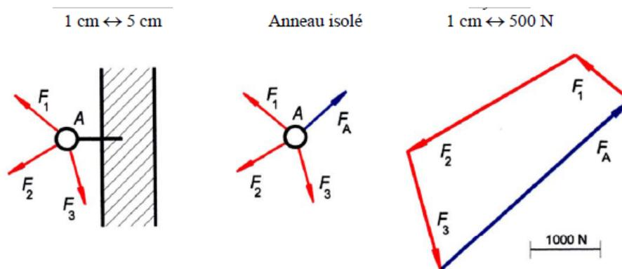
Après avoir choisi un échelle de dessin, on trace le polygone former par les forces appliquées sur l'anneau  $A$  et la réaction  $F_A$ . Puis on mesure la longueur de  $F_A$ , on trouve que  $F_A = 7,25 \text{ cm}$ . Pour obtenir l'intensité de la force la longueur est multipliée par l'échelle de dessin.  $F_A = 7,25 \text{ cm} \times 500 \text{ N/cm} = 3625 \text{ N}$  d'ou l'angle de  $F_A$  est égale à  $41,8^\circ$ .
