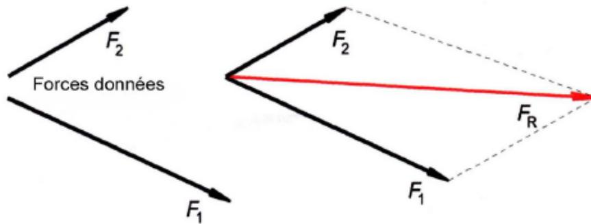
Figure III. 3: Résultante de deux forces (Principe de parallélogramme).
