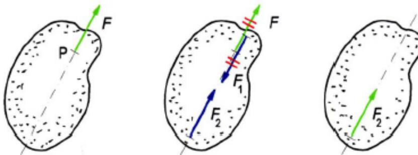
Figure III. 2: Transport d'une force sur sa ligne d'action.
