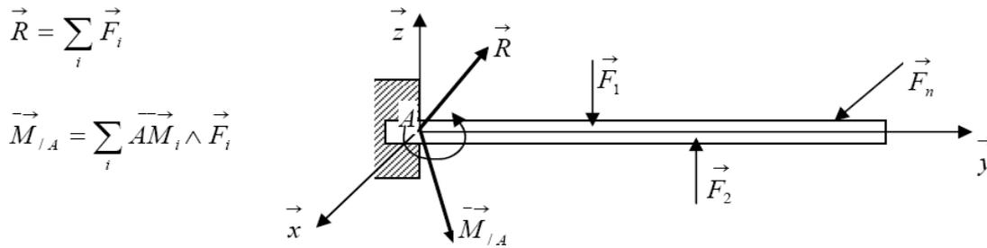
Figure III. 9: Représentation de la réaction d'une liaison encastrement.
