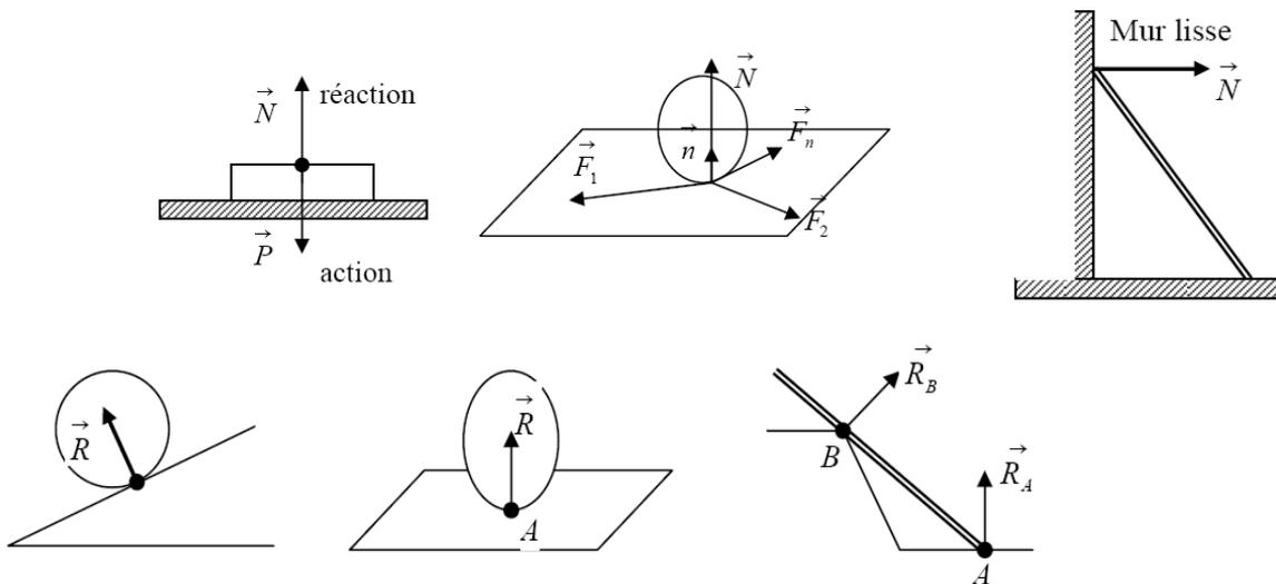
**Figure III. 6:** Différents types des liaisons mécaniques (Appuis simple).
