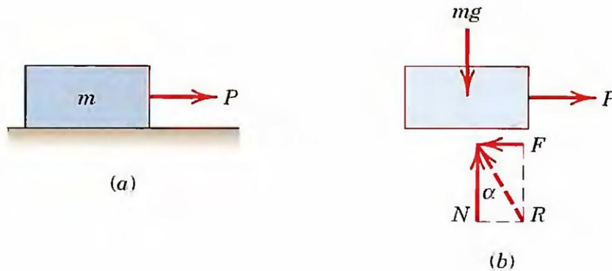
Figure III. 16: Représentation de la force de frottement.
