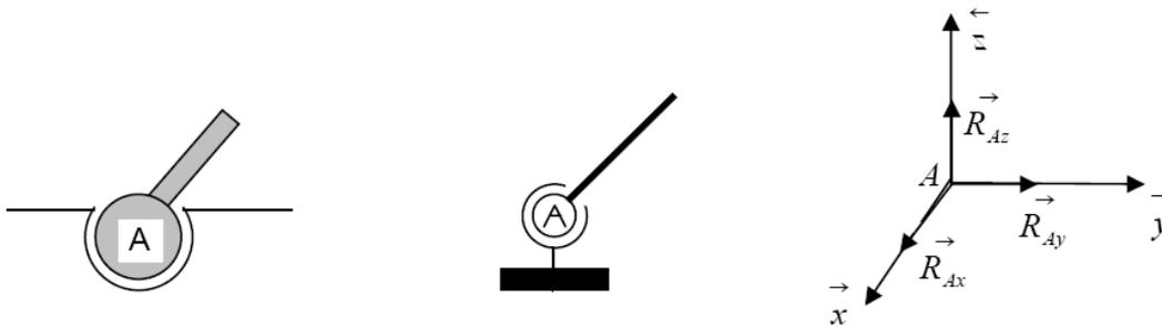
Figure III. 8: Réaction de la liaison rotule.
