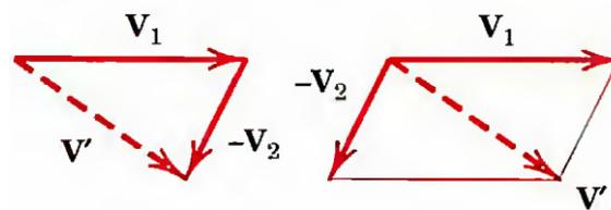
**Figure I. 9:** Soustraction géométrique de deux vecteurs.
