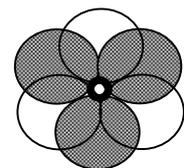
**Fig. 8: Disposition Octaédrique** .Elle montre la constitution d'un octaèdre. Les trois cercles supérieurs appartiennent à une couche compacte supérieur les trois autres appartiennent à une couche compacte inférieur
