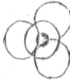
fig. 7: Disposition tétraédrique. Elle montre la constitution d'un tétraèdre. Les trois cercles supérieurs appartiennent à la couche hexagonale, le cercle inférieur représente un oxygène de la couche compacte
