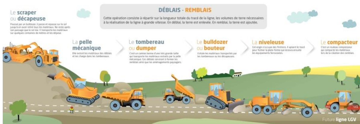
Figure 2. Les travaux et les volumes transportés par engin dans un chantier.
