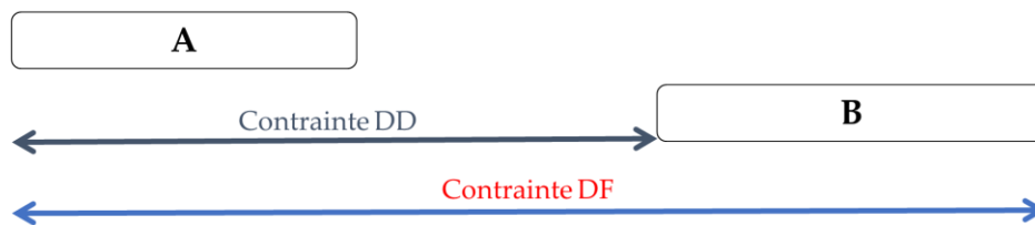
Figure 3. Conversion d'une contrainte Fin-Fin (FF) en contrainte Début-Début (DD).
