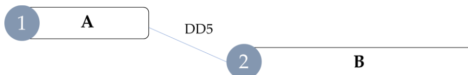
Figure 5. Contrainte Début-Début de deux tâches A et B dans la réalisation d'un projet.
