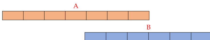
Figure 7. Décrire une contrainte Fin-Fin (FF), et la convertir en contrainte Début-Début (DD) à partir d'un descriptif.
