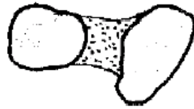
arrangement de sable ou silt avec un liant
