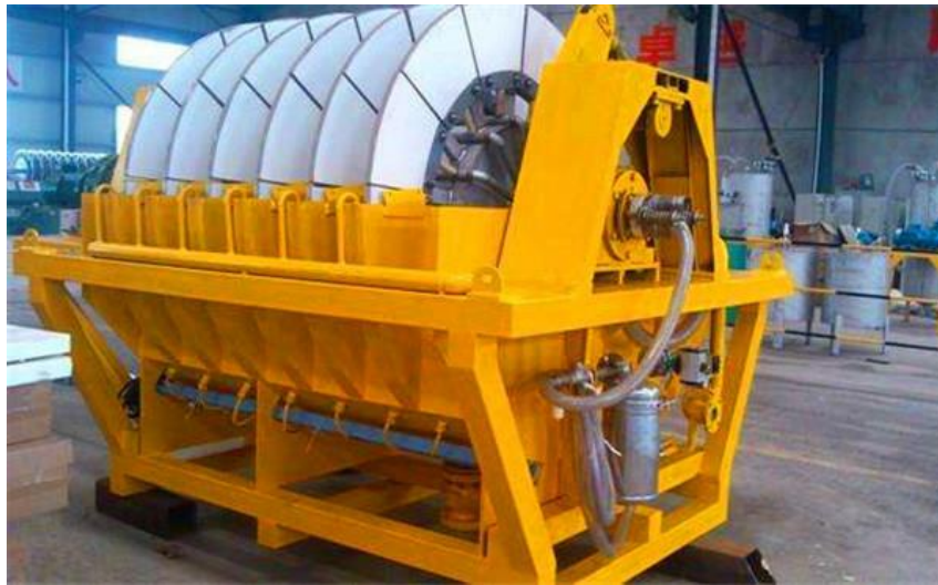
Figure II-1-3 -Le filtre à vide de disque pour la métallurgie (CITICHL )
