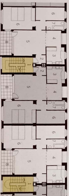
2 Plan des appartements de type B 1:200 1 Escalier d'accès 2 Entrée 3 Cuisine 4 Arrière pour les repas 5 Salle de séjour 6 Chambre 7 Salle de bains 8 Loggia
