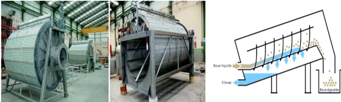
**Figure I.2 :** Schéma d'un Micro-tamis à tambour
