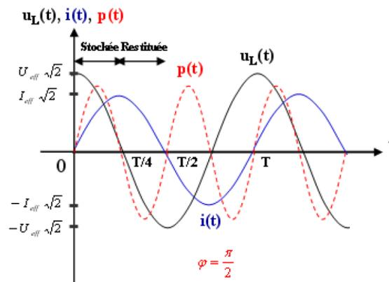
Figure 2.3 : Puissance instantanée pour un dipôle inductif.
