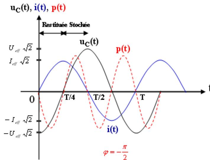
**Figure 2.4 :** Puissance instantanée pour un dipôle capacitif.
