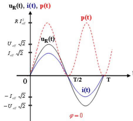
Figure 2.2 : Puissance instantanée pour un dipôle résistif.
