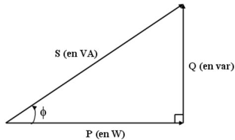
Figure 2.5 : Triangle des puissances (Inductif).
