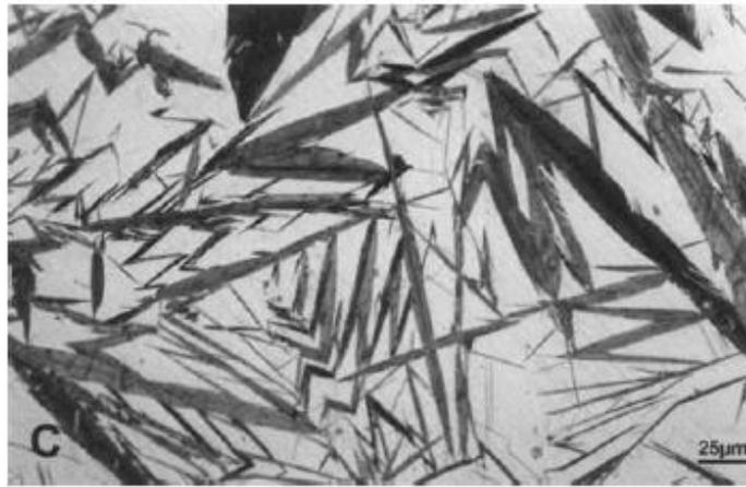
Figure 4-17: Martensite en plaquettes de l'acier Fe-20Ni-0,5C
