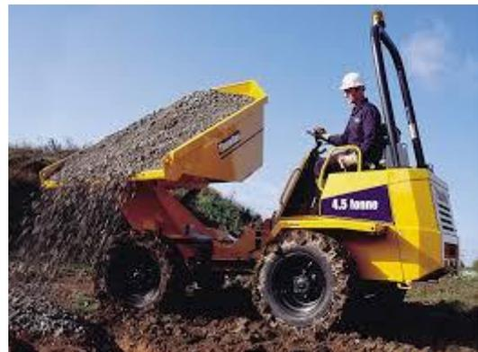
8. le dumper est un engin à l'intérieur du chantier, ayant pour rôle essentiel à l'intérieur du chantier, il permet le transport de tous les matériels et les matériaux dont on a besoin sur site et en particulier lors de l'absence d'une grue.
