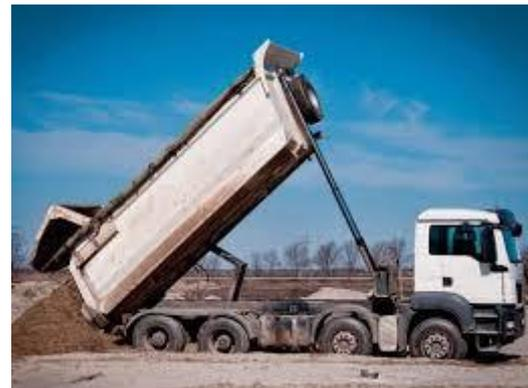
6. le camion benne est un engin de transport de matériaux d'un point de départ à un point d'arrivée, qu'il soit à l'intérieur ou de l'extérieur du chantier, tels que les sables, les graviers de divers fractions, les terres, les matériaux en vrac si nécessaire ainsi que divers matériels et outils en unités.
