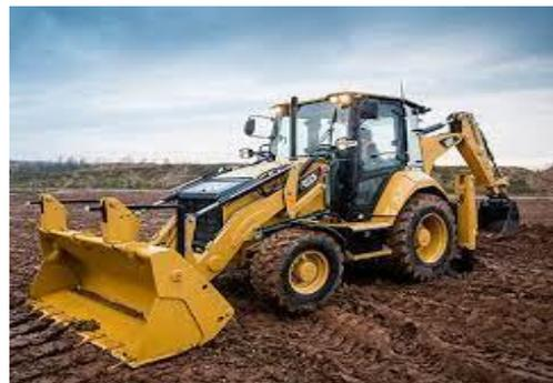
3. l'engin (pelleteuse, pelle mécanique,...) ayant pour rôle de creuser les endroits destinées aux fondations des édifices, les travaux de voirie et réseaux divers ainsi que pour charger les matériaux différents (terres, sables graviers,...).
