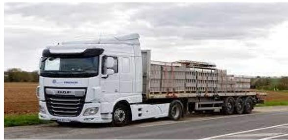
5. le camion plateau est un engin de transport de matériaux d'un point de départ à un point d'arrivée, qu'il soit à l'intérieur ou de l'extérieur du chantier, tels que les briques, les parpaings, les aciers, les matériaux en sacs (ciment, plâtre, adjuvants,...) ainsi que divers matériels et outils en unités.
