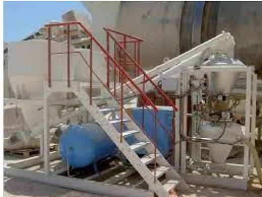
**3. Malaxage des constituants.** Il est réalisé dans une cuve à axe horizontal. Les pales de malaxage sont solidaires de la cuve, le mélange se fait par une rotation de celle-ci.
