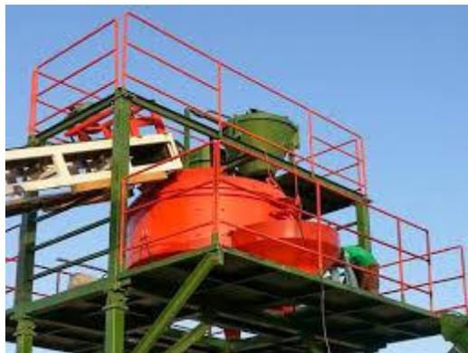
**4. Vidage de la gâchée.** Il est assuré par inversion du sens de rotation de la cuve dans le réceptacle : benne à béton, dumper, camion toupie (malaxeur)...
