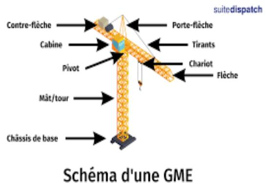
b- grue à tour, est fixe, montée par éléments, à une flèche orientable située sur la partie supérieure de sa tour.
