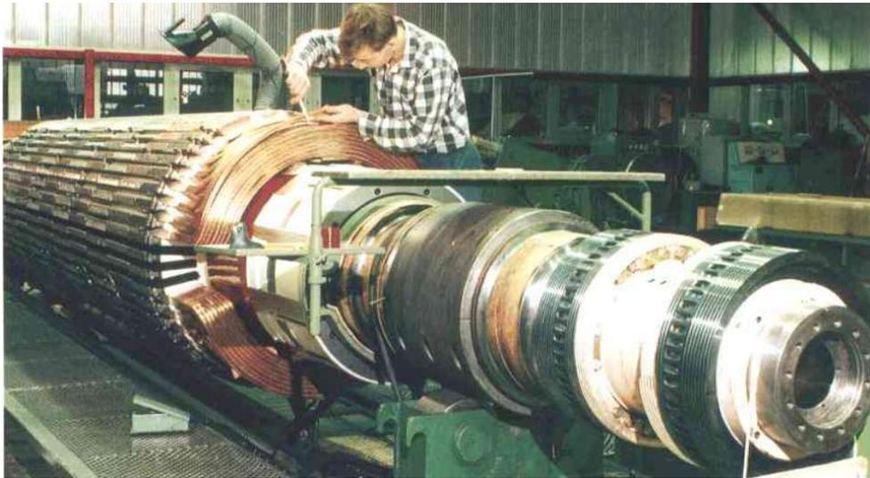
Figure 2 : rotor à pôles lisses
