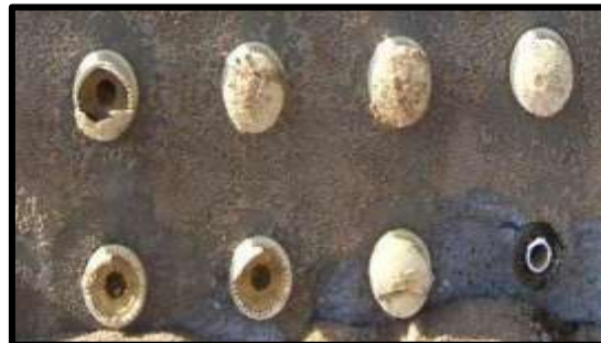
Figure 11: Problèmes rencontrés après plusieurs cycles de lavage du filtre et des conditions de pression de lavage non contrôlées (béton fondu, et busettes détériorées)
