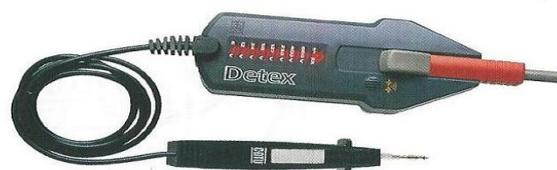
**Figure 3.71** Le vérificateur d'absence de tension
