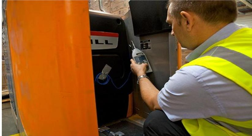
**Figure 4.5** Mesure des vibrations produites par un transpalette avec un vibromètres doc INRS
