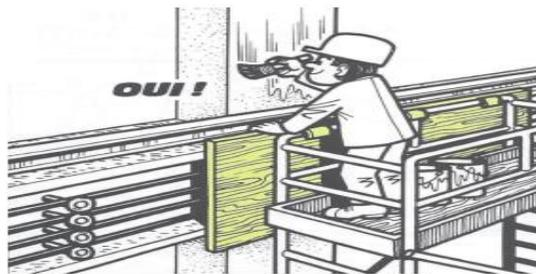
**Figure 3.11** protection par obstacle [2]
