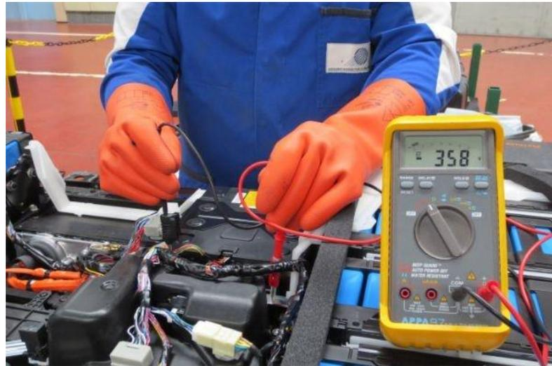
**Figure 3.88** Mesure de tension aux bornes d'une batterie de véhicule électrique
