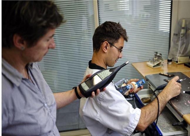
**Figure 4.4** Mesure de niveau sonore à l'aide d'un sonomètre doc INRS
