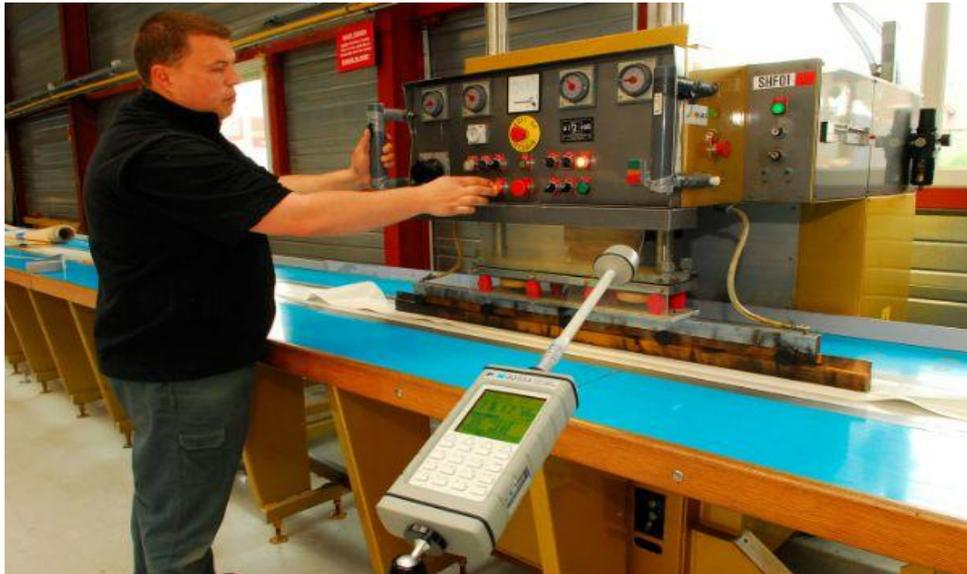
**Figure 3.84** Mesure de champs électromagnétiques sur un poste de soudage haute doc INRS
