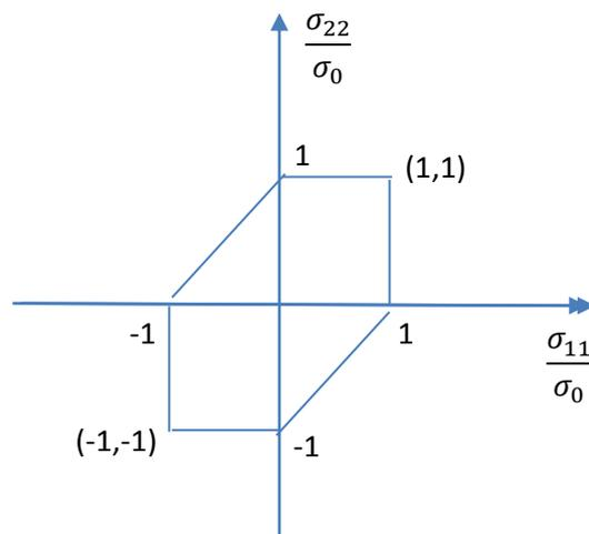
*fig. 6- Hexagone de cisaillement maximum*
