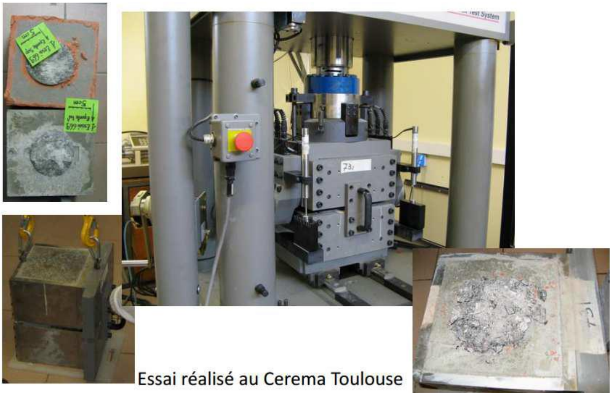
Figure 8. Essai de cisaillement sur discontinuité
