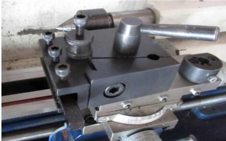
Figure 5. Montage de l'outil
