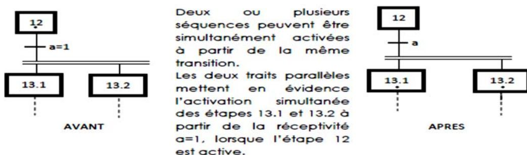
Deux ou plusieurs séquences peuvent être simultanément activées à partir de la même transition. Les deux traits parallèles mettent en évidence l'activation simultanée des étapes 13.1 et 13.2 à partir de la réceptivité a=1, lorsque l'étape 12 est active.
