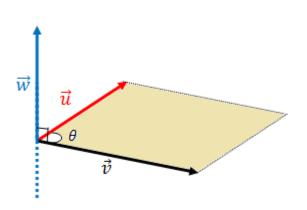
$$\vec{u} \wedge \vec{v} = \begin{vmatrix} \vec{i} & \vec{j} & \vec{k} \\ x_u & y_u & z_u \\ x_v & y_v & z_v \end{vmatrix} = \begin{vmatrix} y_u & z_u \\ y_v & z_v \end{vmatrix} . \vec{i} - \begin{vmatrix} x_u & z_u \\ x_v & z_v \end{vmatrix} . \vec{j} + \begin{vmatrix} x_u & y_u \\ x_v & y_v \end{vmatrix} . \vec{k}$$
