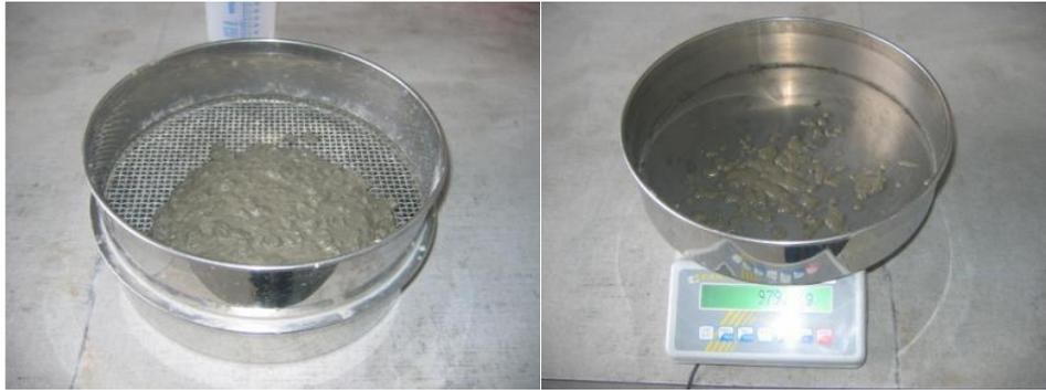
**Figure I.3** Essai de stabilité au tamis
