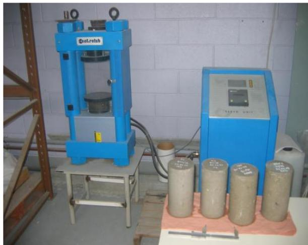
*Figure I.8 Essais de compression*
