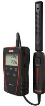
*L'appareil AQ 110 Kimo assure la mesure du niveau du dioxyde de carbone (CO<sub>2</sub>) présent dans l'air ambiant*
