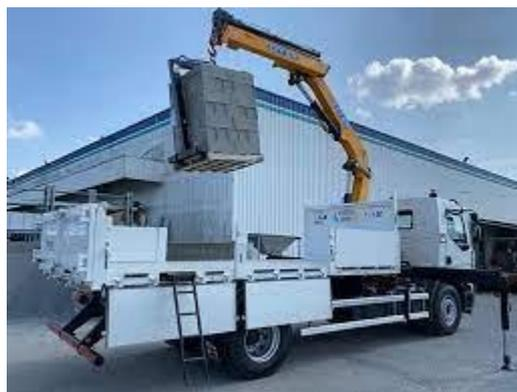
c- grue auxiliaires sur véhicule, a un bâti monté sur un châssis de camion et une colonne sur laquelle s'articule une flèche repliable ou télescopique.
