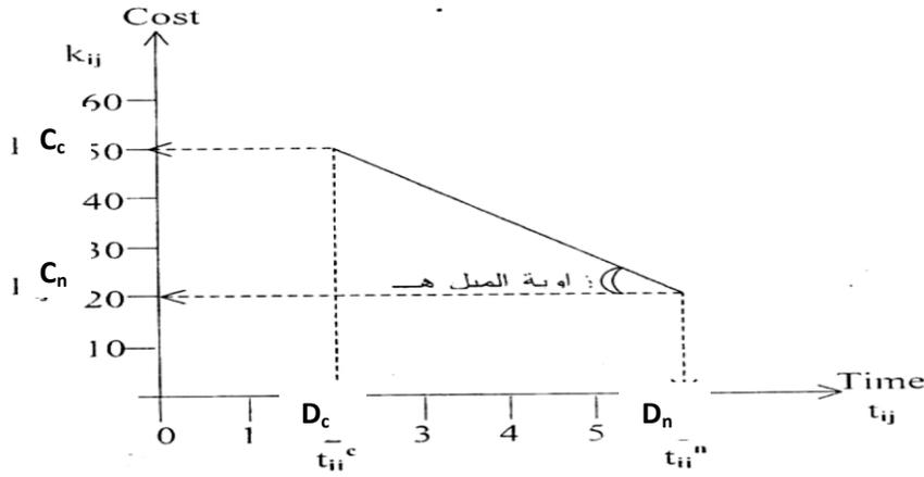
باعتبار التكلفة دالة في زمن التنفيذ فيلاحظ أنه في عند التكلفة  $C_n$  كانت مدة تنفيذ النشاط هي  $D_n$  ، وعندما بدلنا الوقت بالتكلفة أي أضفنا التكلفة لتصبح  $C_c$  فقد انخفضت مدة النشاط لتصل الى  $D_c$  . ما يعني وجود علاقة خطية عكسية بين الزمن و التكلفة حيث ميل هذه العلاقة يظهر أثر تخفيض وحدة زمنية واحدة على التكلفة والذي يساوي :
