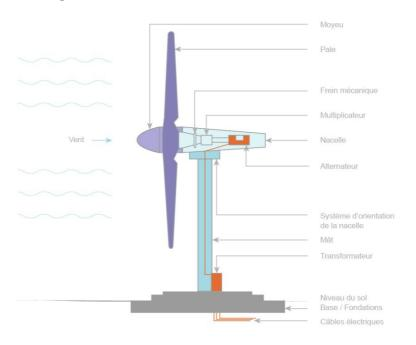
Une éolienne transforme l'énergie du vent en énergie électrique. Cette transformation se fait en plusieurs étapes [29]:
