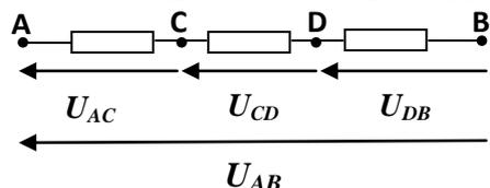
Fig. 2.2 Tension aux bornes d'un circuit
