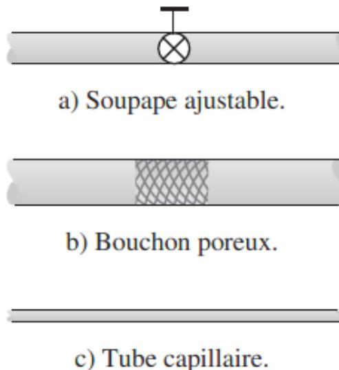
Figure 1.1 Exemples de soupapes d'étranglement
