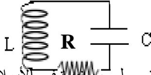
غير أن الواقع هو وجود مقاومة حتى ولو صغيرة في الأسلاك الموصلة وفي الملف مما يتسبب في استنزاف الطاقة علي هيئة حرارة، علماً بأن الطاقة المستنزفة تتناسب مع مربع التيار في الشكل (٥-٣١):  $R I^2$ ، حيث  $R$  المقاومة ومكثف ومقاومة  $LCR$  الدائرة في صورتها الحقيقية بوجود المقاومة  $R$  كما في الشكل (٥-٥).
