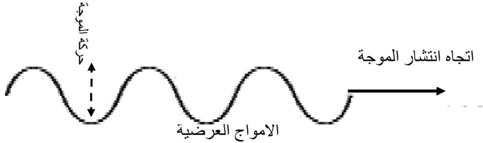
كذلك فان الامواج الكهربية المغنطيسية هي من هذا النوع رغم انها لا تتحرك في وسط مادي حيث يتغير كل من المجال الكهربائي والمجال المغنطيسي في المستوى العموي علي اتجاه انتشار الموجة كما في الشكل (٧-٣). الموجة الكهرومغنطيسية تقوم بنشر الطاقة عبر الفراغ عن طريق المجال المغنطيسي والمجال الكهربائي.
