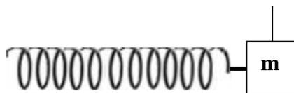
الشكل (٢-٤) يوضح أن طاقة الوضع والطاقة الحركية تتبادل عند تحرك الزنبرك فعند  $x = \pm A$  تصبح الطاقة كلها طاقة وضع بينما عند  $x = 0$  تصبح الطاقة كلها طاقة حركة
