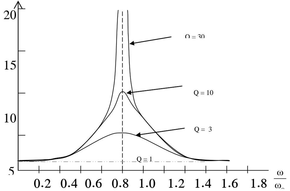
الشكل (4-6) : تغير  $\frac{A(\omega)}{A(0)}$  مع  $\frac{\omega}{\omega_0}$  مع قيم مختلفة لـ  $Q$  بافتراض أن اتساع القوة الخارجية  $F_0$  ثابت
