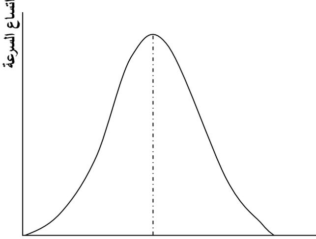
شكل (6-7) : رنين السرعة يحدث بالضبط عند  $\omega_0 = \omega$
