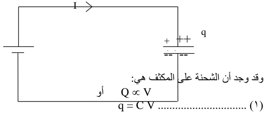
حيث C ثابت التناسب ويسمى سعة المكثف Capacitance ولفهم معنى هذا الثابت نلاحظ في المعادلة أعلاه أنه لنفس فرق الجهد V فإن الشحنة q على المكثف تزيد بزيادة السعة C وهي بالتالي تحمل نفس مفهوم سعة الوعاء. ونجد أن سعة المكثف (أنظر شكل المكثف أعلاه) تتوقف علي:
