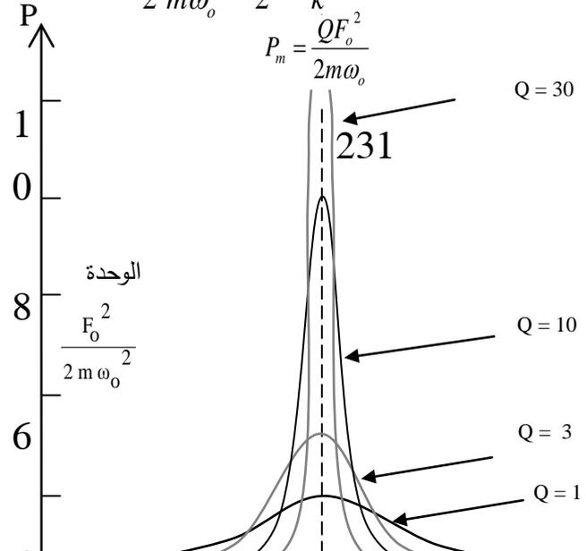
المنحنيات في الشكل (8-6) تسمى منحنيات رنين القدرة  $s$  Power resonance curve
