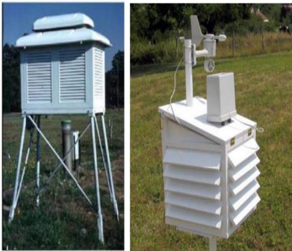
Fig n° 1 : Photos d'abris météorologiques.
