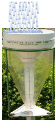
Pluviomètre à lecture direct
