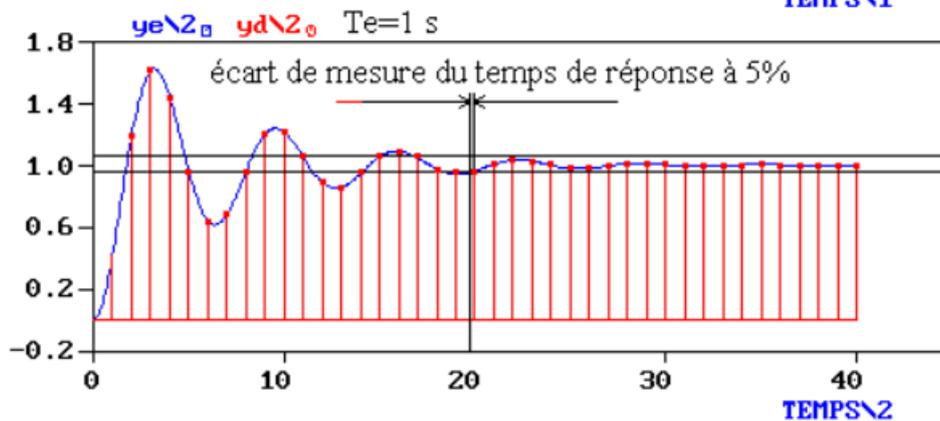
Entre le temps de réponse d'un système échantillonné et le temps de réponse de son équivalent continu il existe un écart dû à l'ignorance du comportement entre les instants d'échantillonnage. Plus la période d'échantillonnage est grande, plus cet écart risque d'être important.
