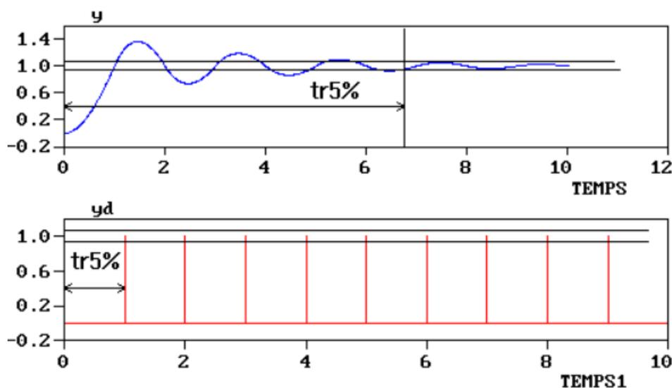
La présence des oscillations cachées rend impossible une estimation correcte de la rapidité d'un système échantillonné à partir des valeurs de sa réponse indicielle aux instants d'échantillonnage.
