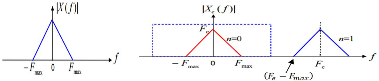
Figure 2.1: Spectre du signal échantillonné
