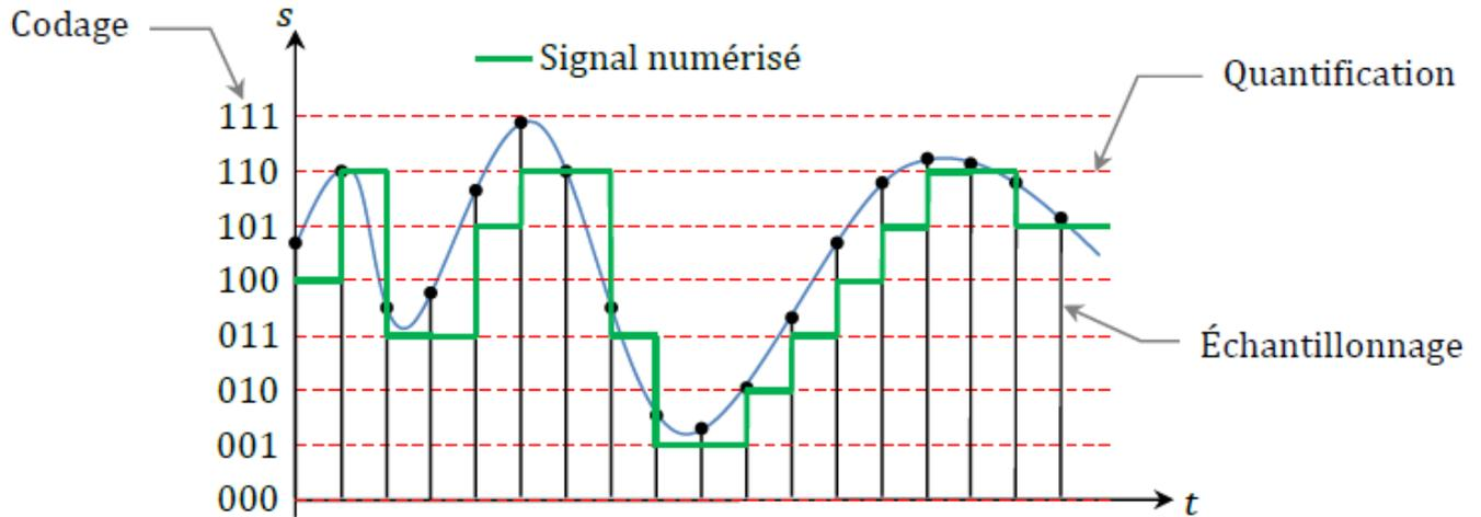
Figure 2.2: Échantillonnage, quantification et codage d'un signal
