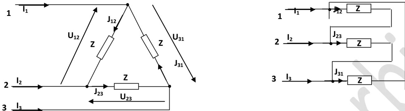
Fig.3.10. Couplage triangle du récepteur triphasé
