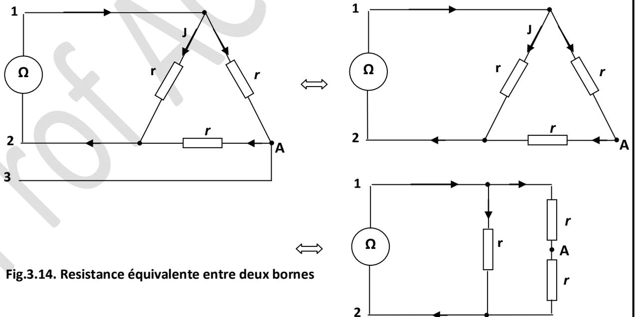
Fig.3.14. Resistance équivalente entre deux bornes
