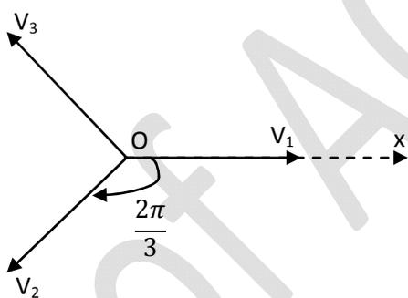
a. Diagramme de Fresnel des tensions simples triphasée
