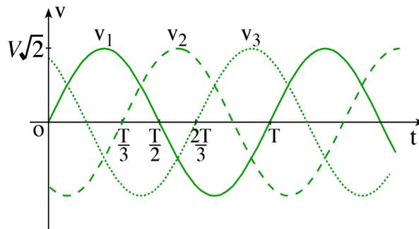
Fig. 3.3 les tensions simples  $v_1(t)$ ,  $v_2(t)$  et  $v_3(t)$
