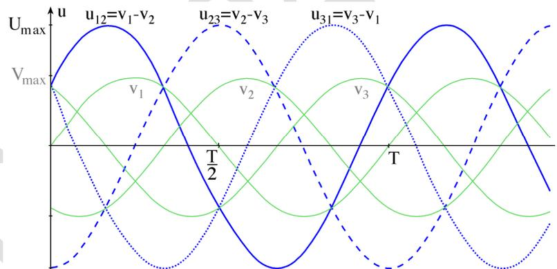
Fig. 3.6. Le système des tensions composées et des tensions simples instantanées
