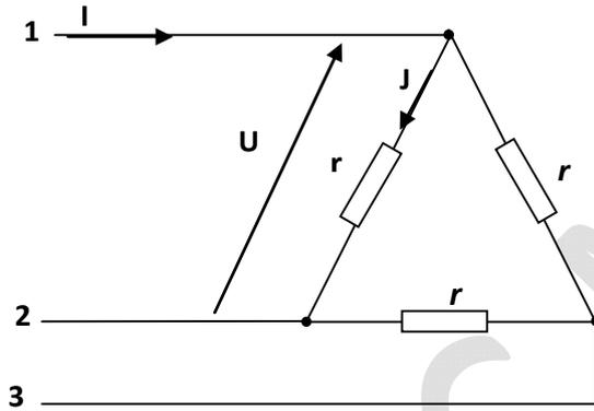
Fig.3.13. Calcul des pertes joules en couplage triangle
