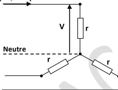
Fig3.11. Calcul des pertes joules en couplage étoile
