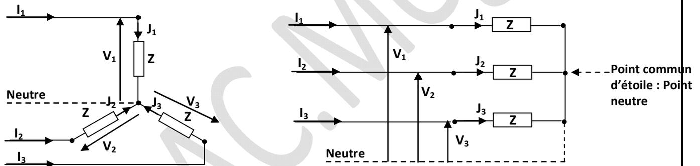
Fig.3.9. Couplage étoile du récepteur
