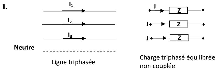
Fig.3.8. Courant en ligne et courant par phases
