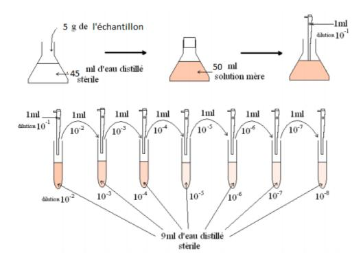
Figure 1 : Procédé de dilution de l'échantillon.
