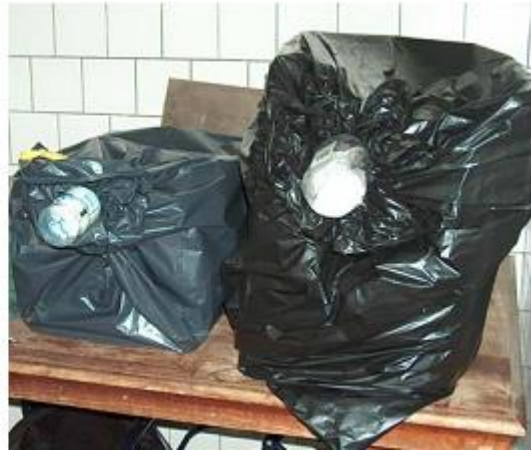
Photo 14 : Caisse d'émergence avec collecteur sous forme de demi-bouteille en plastique).
