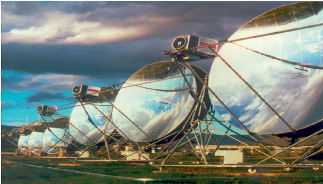
FIGURE 1.6 – système Parabole/Stirling.
