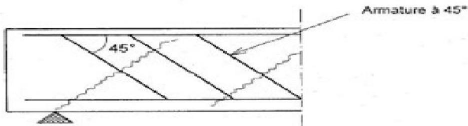
Cependant pour des facilités de réalisation et parce que leur efficacité est peut amoindrie, les armatures transversales sont le plus souvent perpendiculaires à la fibre neutre.
