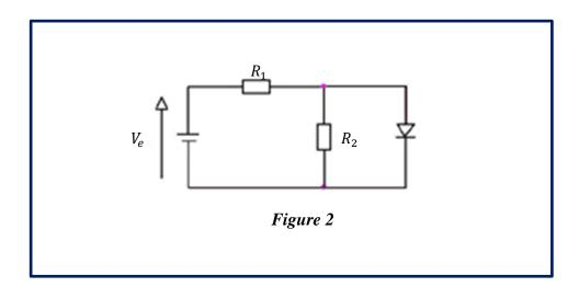
On suppose que la tension seuil de la **diode** est  $V_d=0.6V$  et sa résistance dynamique interne est nulle. La résistance  $R_1=200\Omega$ ,  $R_2=500\Omega$  et  $V_e=12V$  (la tension de générateur)
