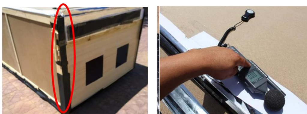
Figure 30. Test d'étanchéité (source : Daich, 2019)
