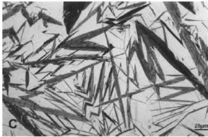
Figure 4-17: Martensite en plaquettes de l'acier Fe-20Ni-0,5C
