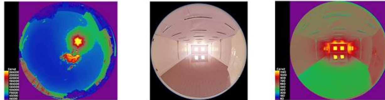
Figure 5. L'ambiance lumineuse intérieure du modèle équipé de Plafond anidolique à 10 h
