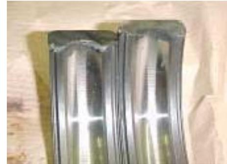
La dégradation d'un roulement (plus de 60 /°) de défauts dans les machines tournantes se traduit généralement par un écaillage des surfaces en contact (bagues et éléments roulants) qui s'étend et évolue dans le temps. La dégradation peut être localisée ou généralisée.
