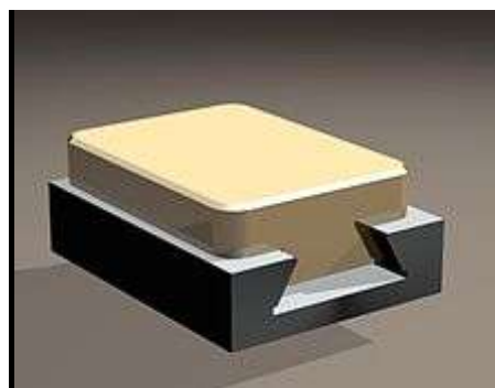
Figure 3. Liaison glissière réalisé par une queue-d'aronde
