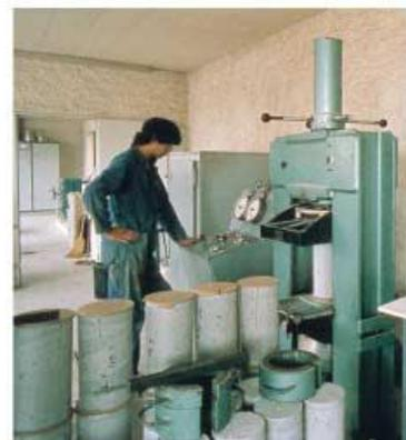
**Figure 7.4 :** Ecrasement d'éprouvettes de béton avec une presse hydraulique
