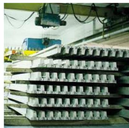
**Figure 9.5 :** Poutrelles précontraintes par pré-tension
