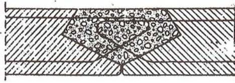
Fig. 03 : Eléments préfabriqués solidarisés par armature
