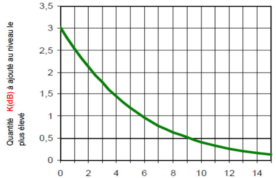
Fig 02: Diagramme de détermination des valeurs K(dB) http://acoustiquebatiment.e-monsite.com/pages/caracteristiques-energetiques-des-sons.html
