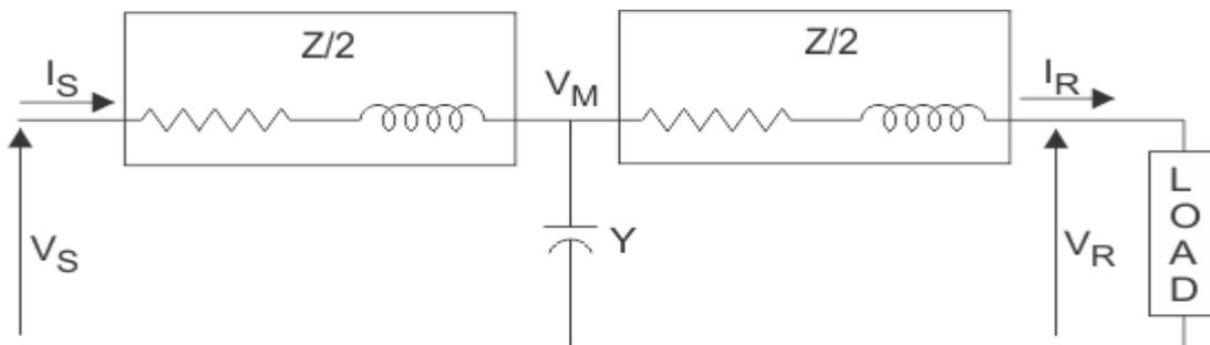
Figure 4 :Modèle de ligne moyenne en T
