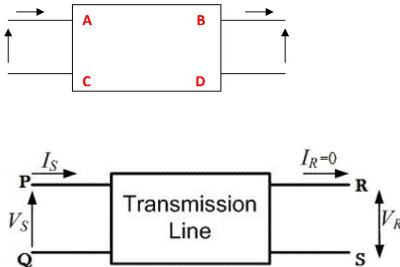
Figure 1 : Modèle de réseau en quadripôle
