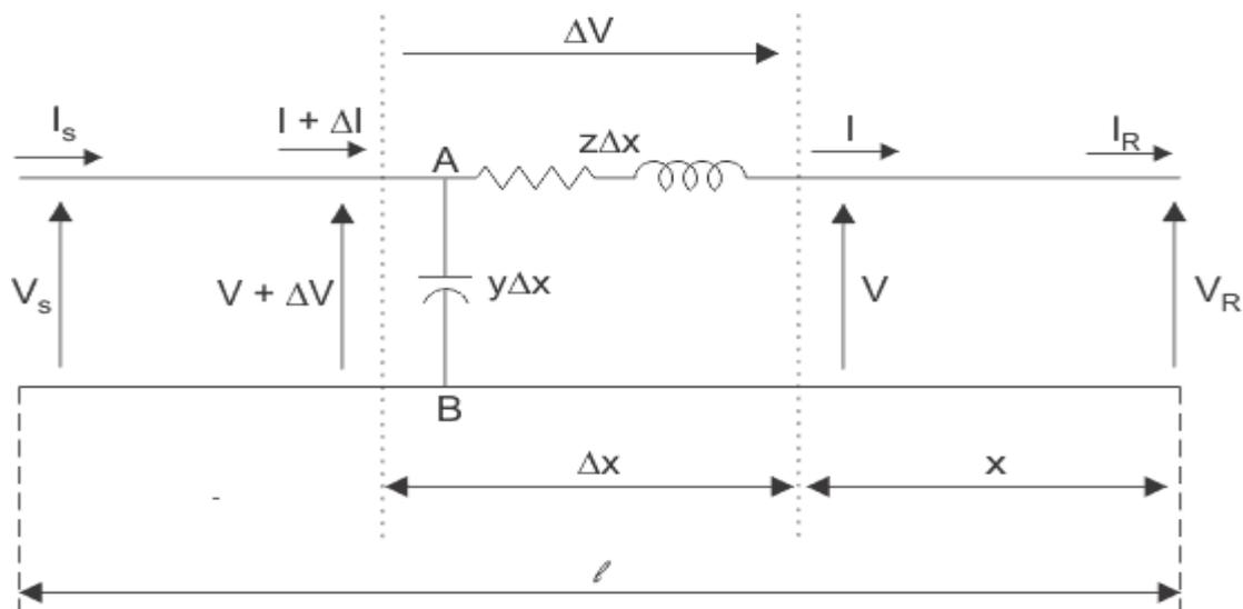
Figure 5 :Modèle de longue ligne
