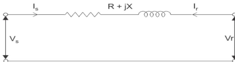
Figure 2 : Modèle d'une ligne courte
