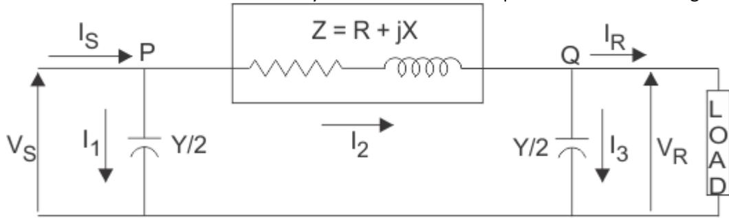
Figure 3 :Modèle de ligne moyenne en  $\pi$
