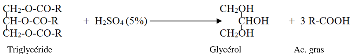
Figure 36 : hydrolyse acide d'un triglycéride.
