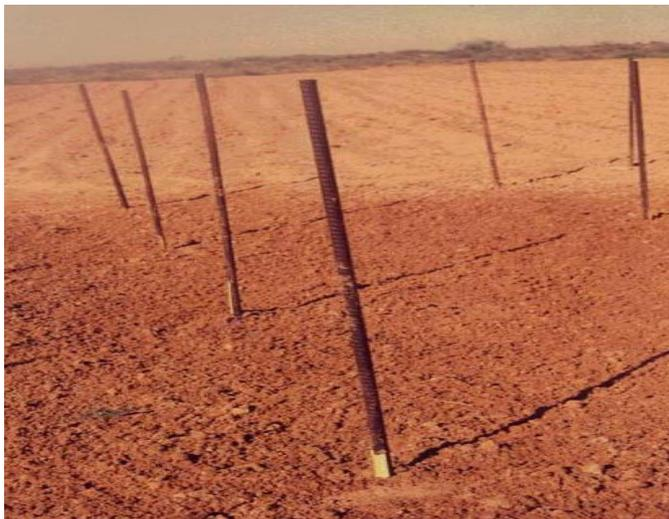
**Photo 02 :** La méthode des piquets utilisée sur le terrain pour quantifier l'érosion éolienne (Kardous, 2005).
