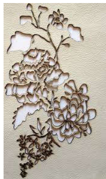
Fig. 3.21. Exemple de forme réalisé au laser à source CO 2 .
