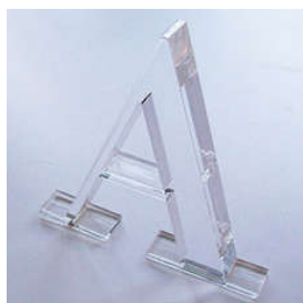
Fig. 3.23. Exemple de forme réalisé au Laser YAG.
