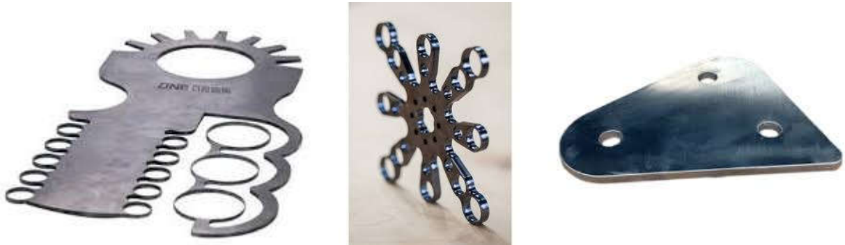
Fig. 3.25. Exemple de forme réalisé au Laser fibre.
